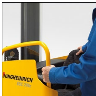
Поручень для безопасной посадки, а также для установки различных опционных устройств
