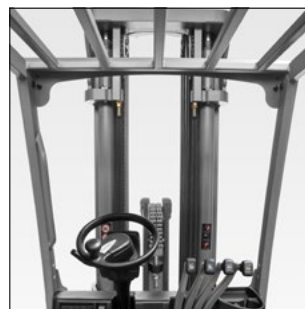
Улучшенный обзор груза, благодаря оптимизации конструкции мачты
