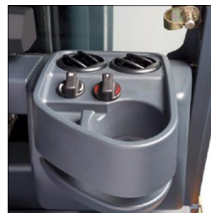
Отопитель, включая дефлекторы обдува переднего стекла
